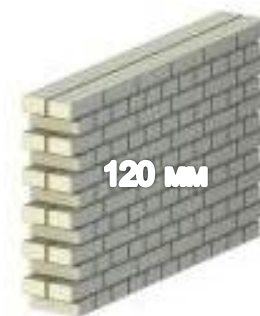
Стена из силикатного кирпича Толщина 120 мм масса 450 кг/м 2 R w 52 дБ
