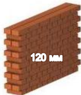
Стена из красного кирпича Толщина 120 мм масса 480 кг/м 2 R w 52 дБ
